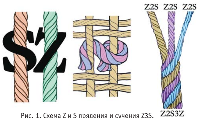
Рис. 1. Схема Z и S прядения и сучения Z3S.
